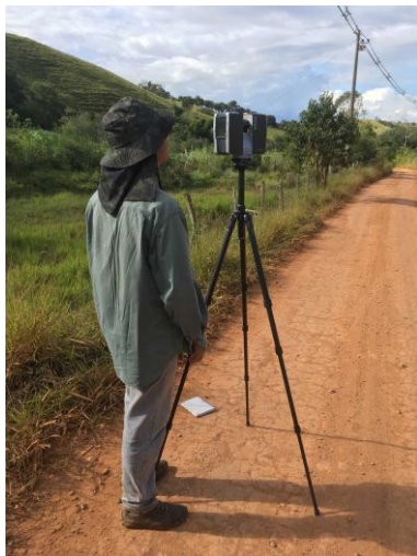
Figura 1: Imagem do LiDAR (Light Detecting and Ranging) gerando a nuvem de pontos.
